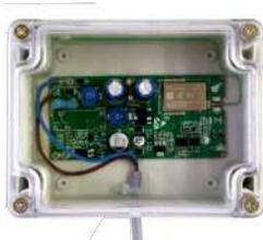
Позволяет управлять световым потоком светильников в зависимости от интенсивности естественного освещения.
