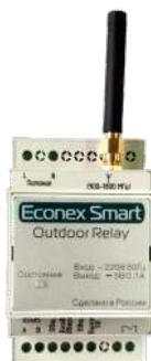
Модуль предназначен для управления силовыми магнитными пускателями (контакторами), используемыми для линий наружного освещения по заданному расписанию в автоматическом режиме или дистанционно командами диспетчера. Модуль позволяет осуществлять контроль и диагностику работы линий наружного освещения, а также дистанционно считывать показания с трехфазного счетчика электрической энергии.
