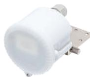
Датчик предназначен для включения/отключения и управления осветительной установкой в зависимости от наличия или отсутствия движущихся объектов в зоне обнаружения. Датчик имеет регулировку чувствительности, задержки отключения, задержку на управление и освещенности. Датчик устанавливается на любую конструкцию.
