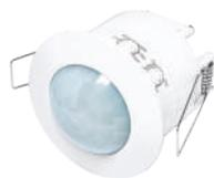
Датчик предназначен для включения/отключения осветительной установки в зависимости от наличия или отсутствия людей в зоне обнаружения, а также от величины освещенности от сторонних источников света. Датчик имеет функцию задержки отключения и освещенности, встраивается в фальшпотолок.
