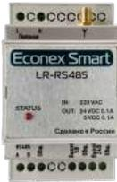
Модуль приема управляющего сигнала по радиоканалу и дальнейшей передачи его исполнительным устройствам по интерфейсу RS485 и обратно.
