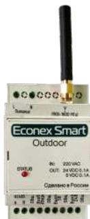
Модуль предназначен для управления силовыми магнитными пускателями (контакторами), используемыми для линий наружного освещения по заданному расписанию в автоматическом режиме или дистанционно командами диспетчера при помощи устройства EconexContact 4, EconexContact 16. Модуль позволяет осуществлять контроль и диагностику работы линий наружного освещения, а также дистанционное считывание показаний с трехфазного счетчика электрической энергии.
