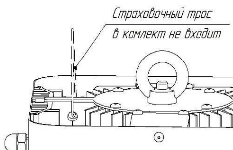
Рисунок 7. Схема расположения отверстия для страховочного крепления
