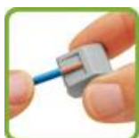
Снять изоляцию на 9-10 мм.
