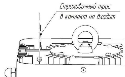
Рисунок 8. Схема расположения отверстия для страховочного крепления
