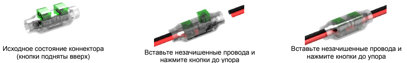
Рисунок 4. Подключение специального герметичного коннектора
