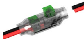
Вставьте незачищенные провода и нажмите кнопки до упора
