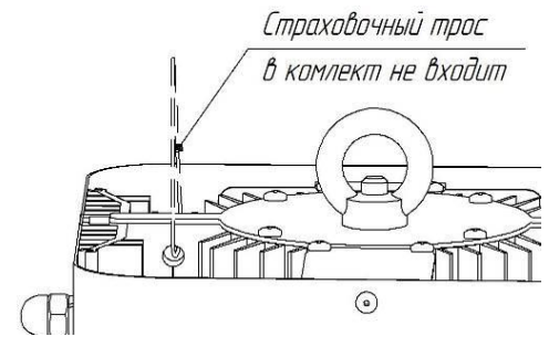
Рисунок 8. Схема расположения отверстия для страховочного крепления
