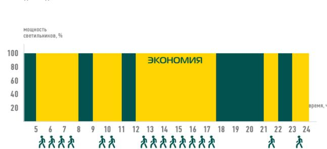
КОМБИНИРОВАННЫЙ РЕЖИМ. RF SENSORLUX+ RF SENSORMOVE
