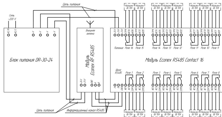
Пример схемы для управления освещением на основе
