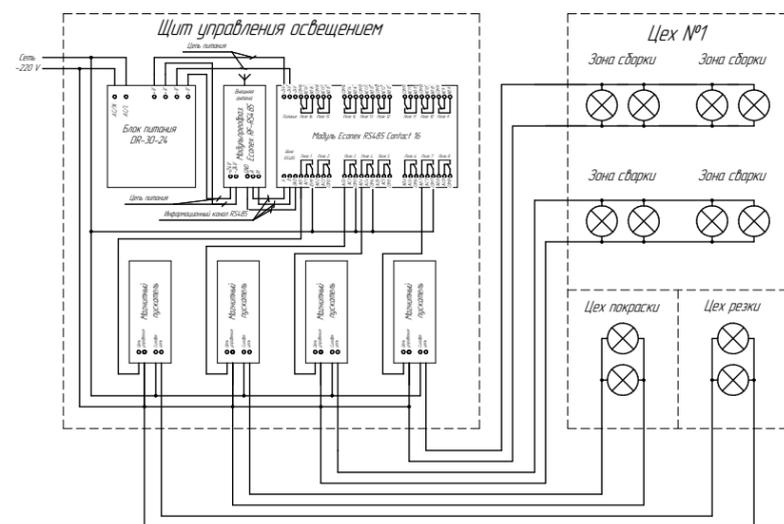
Схема электрическая подключения модулей и датчиков
