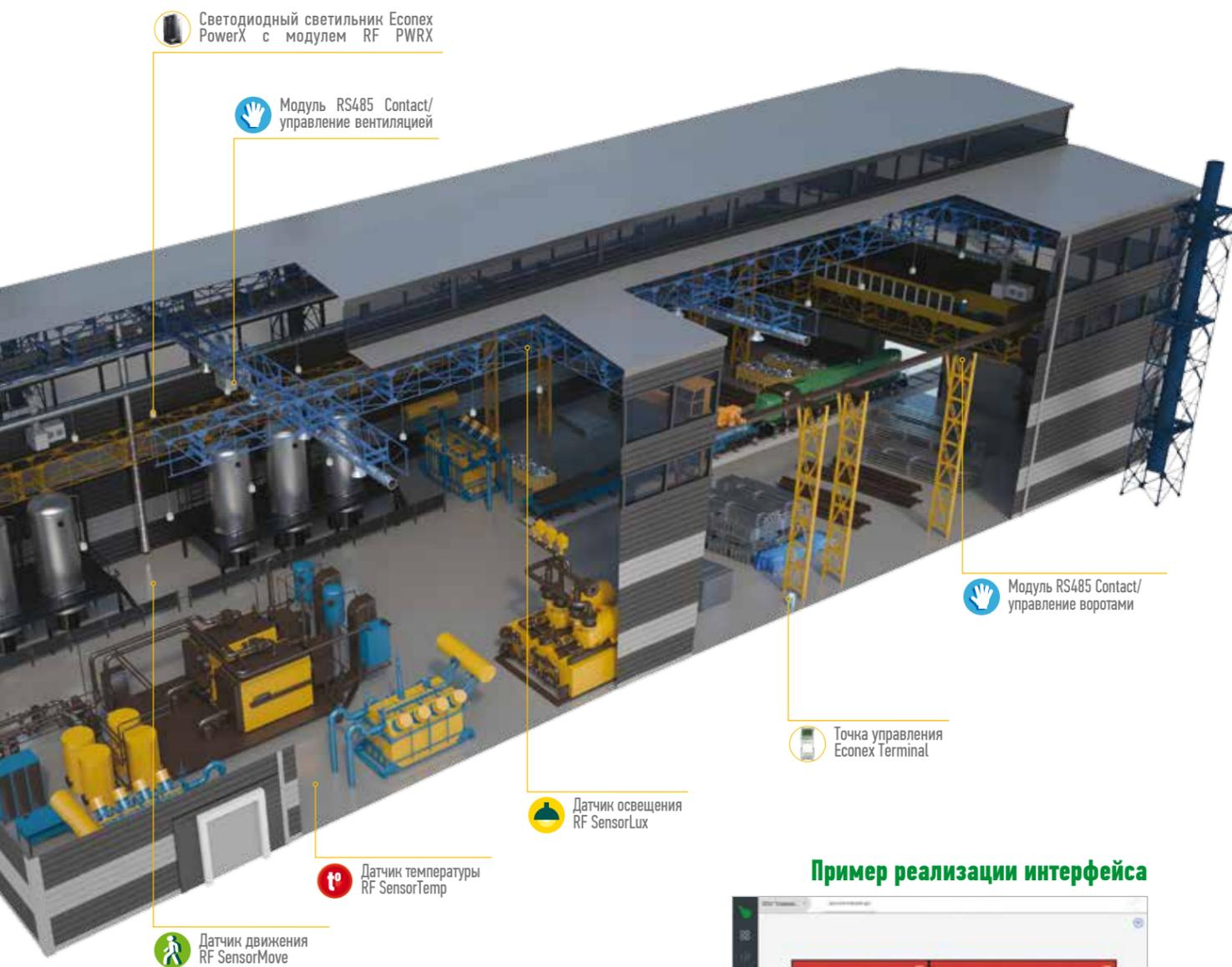
Светодиодный светильник Econex PowerX с модулем RF PWRX
