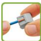
Снять изоляцию на 9-10 мм.
