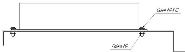
Рисунок 4. Установка блока питания к кронштейну.
