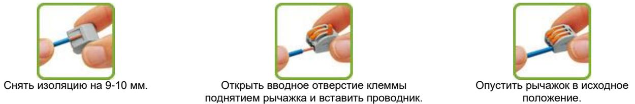
**Рисунок 11.** Подключение проводников с помощью универсальных клемм.
