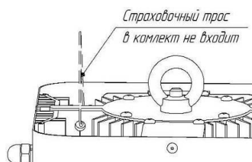
Рисунок 7 Схема расположения отверстия для страховочного крепления
