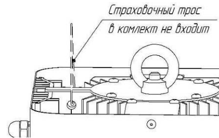
Рисунок 7 Схема расположения отверстия для страховочного крепления
