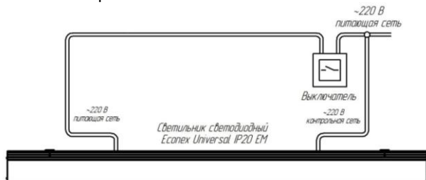
Рисунок 6. Схема подключения светильника серии Econex Universal IP20 EM
