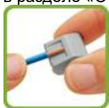
Снять изоляцию на 9-10 мм.
