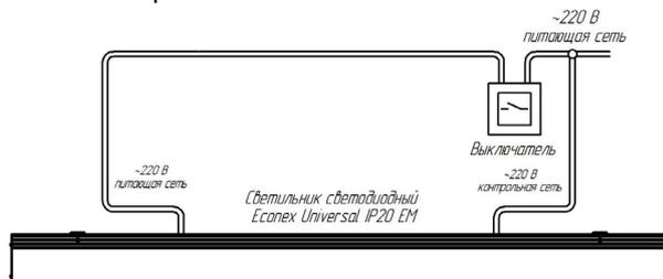
**Рисунок 6.** Схема подключение светильника серии Ecomex Universal IP20 EM
