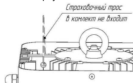
Рисунок 7 Схема расположения отверстия для страховочного крепления
