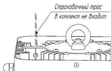
Рисунок 5. Схема расположения отверстия для страховочного крепления
