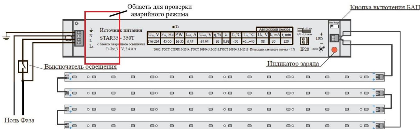
Рисунок 4. Схема электрическая принципиальная
