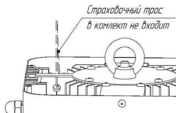
Рисунок 7. Схема расположения отверстия для страховочного крепления
