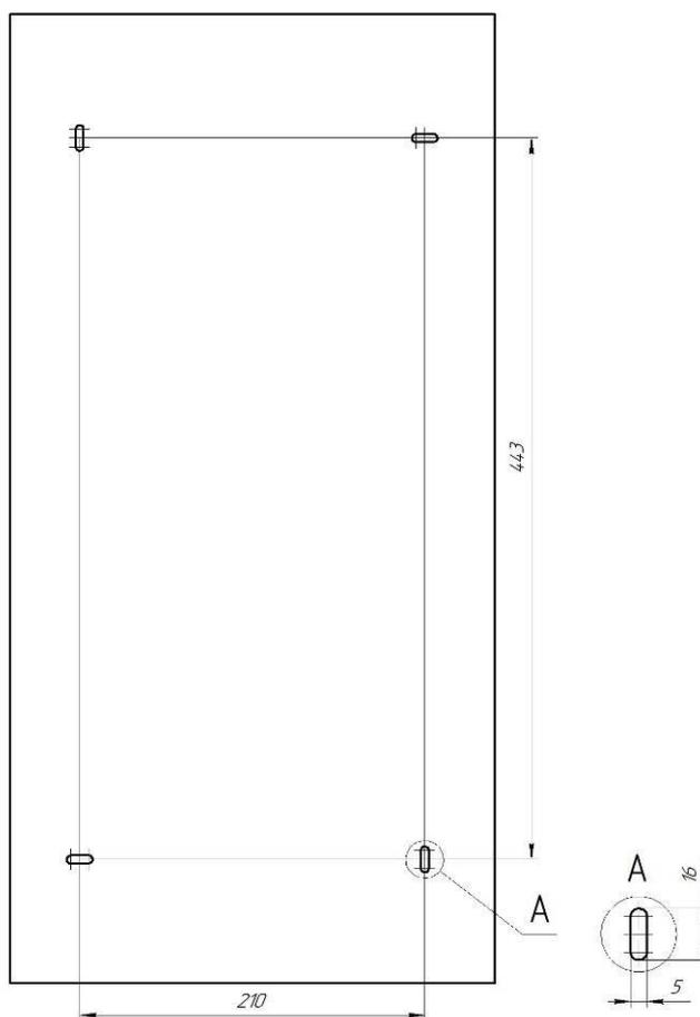
Рисунок 3. Расположение установочных отверстий на корпусе светильника Ecomex Office 295 для накладного монтажа.
