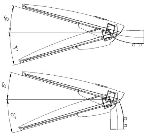
**Рисунок 3.** Варианты крепления светильников серии Highway G2
