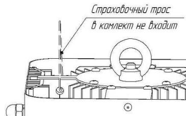
Рисунок 7 Схема расположения отверстия для страховочного крепления
