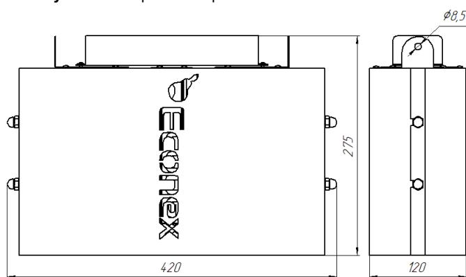
Рисунок 3. Габаритный чертеж светильника PowerX 240 G2
