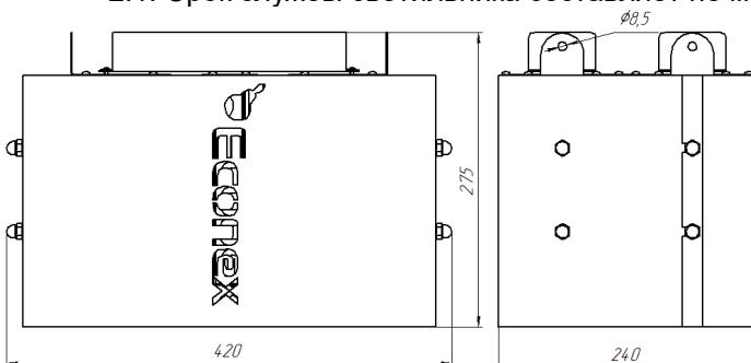
Рисунок 1. Габаритный чертеж светильника PowerX 480 G2
