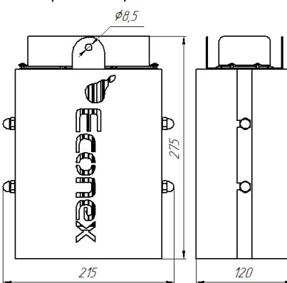
Рисунок 4. Габаритный чертеж Светильника PowerX 80/120 G2
