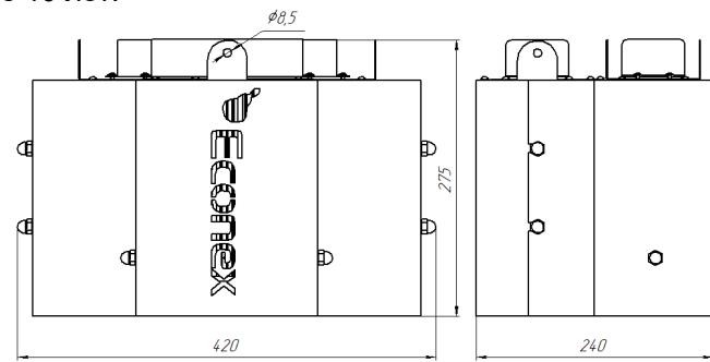
Рисунок 2. Габаритный чертеж светильника PowerX 360 G2
