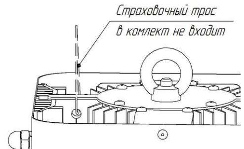
Рисунок 9. Схема расположения отверстия для страховочного крепления
