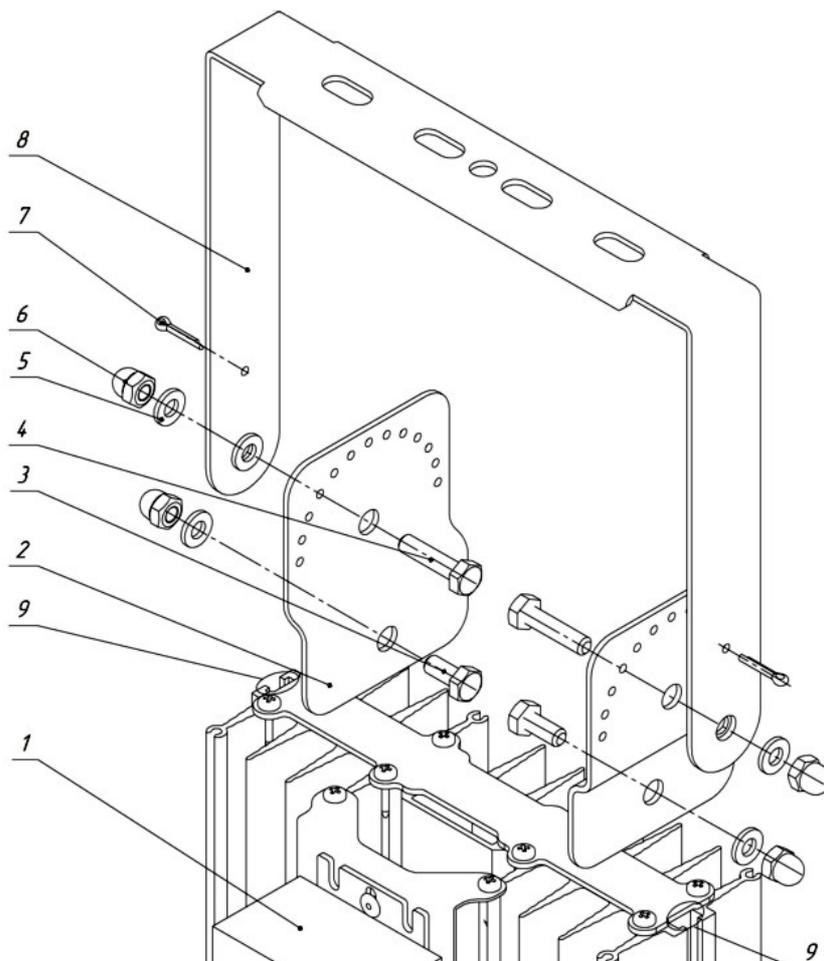
**Рисунок 2. Схема крепления светильника**
