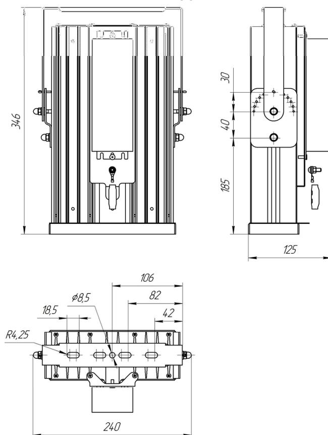
**Рисунок 1.** Габаритный чертеж светильника Econex Power с установленным комплектом крепления
