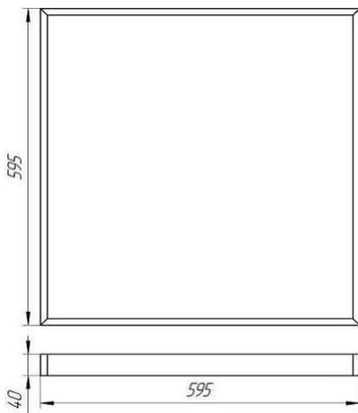
**Рисунок 1.** Габаритный чертеж Ecomex Office 595 AN
