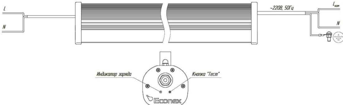
Рисунок 4. Подключение светодиодного светильника Econex Loft EM
